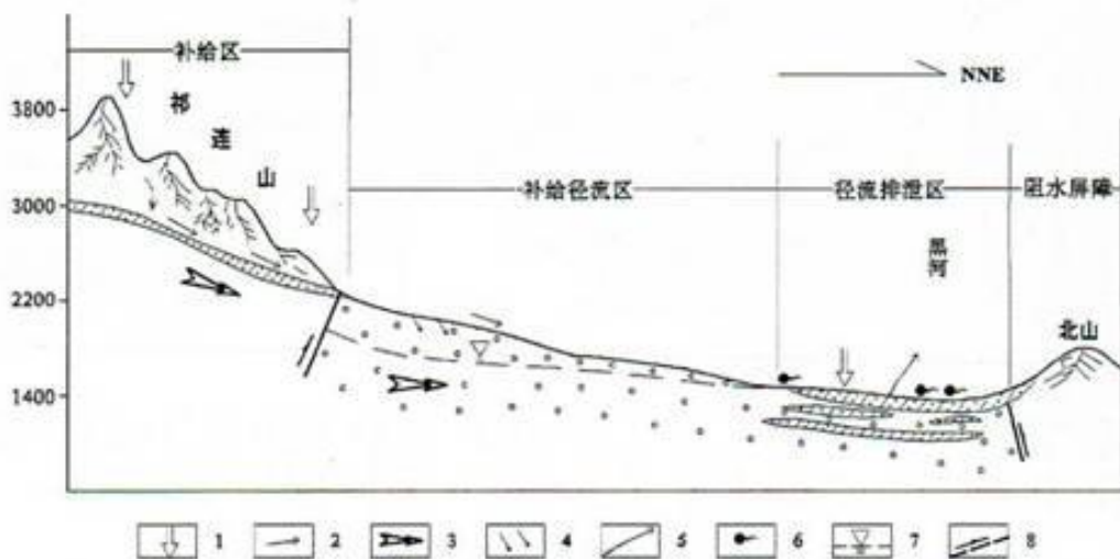
图7 张掖盆地地下水补给、径流、排泄示意剖面
